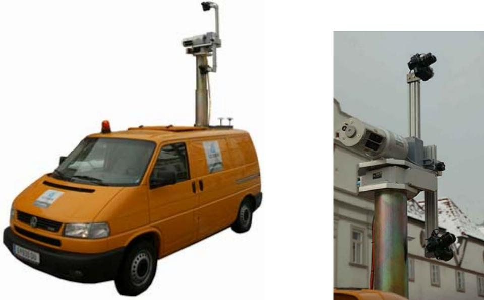
Abb. 1: CityGRID Scanner und Detail der Sensorik
