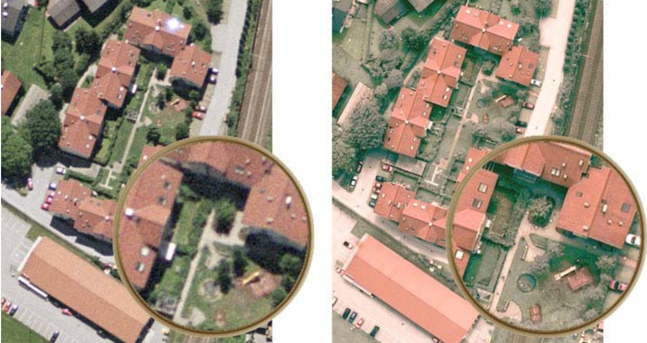
Abb. 4: Auf Filmmaterial (links) bzw. mit der UltraCam D (rechts) aufgenommene Echtfarben-Bilder (Vexcel Imaging Austria)
