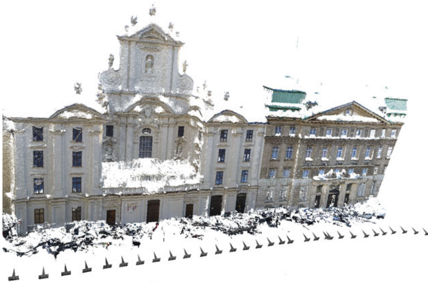
Abbildung 4: Ausschnitt aus dem 3D-Vektormodell, im Vordergrund die berechneten Aufnahmepositionen entlang der Trajektorie
