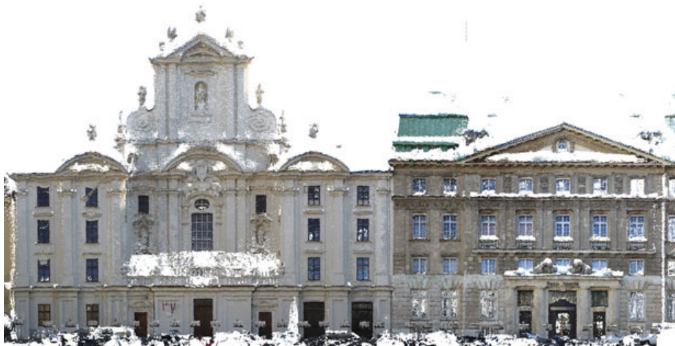
Abbildung 5: Ausschnitt aus dem True-Orthobild. Die Lücken im Bild sind eine Folge der Sichthindernisse bei der Aufnahme und können durch generische Textur gefüllt werden.
