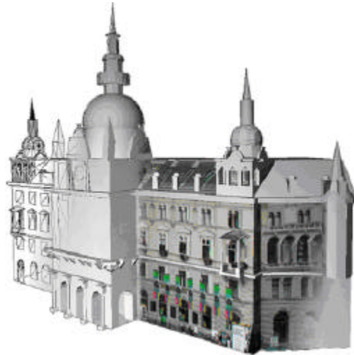
Abbildung 14: Vektormodell einer Fassade, erstellt aus Laser- und Bilddaten
